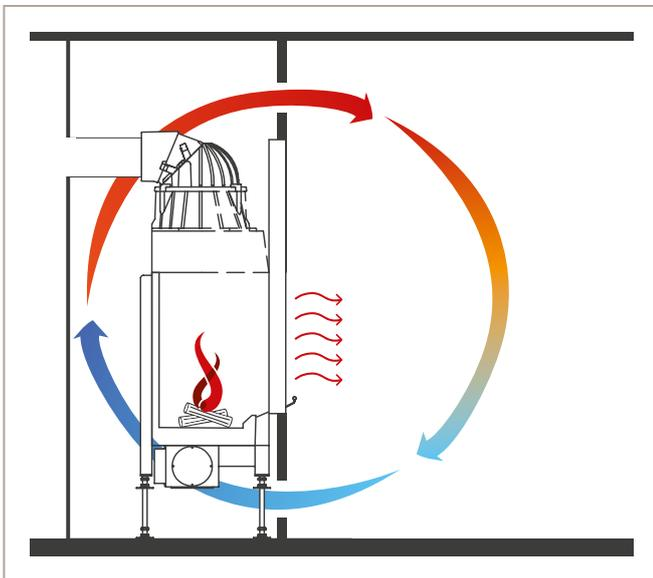
Abb. 13: Heizkreislauf, Schema
