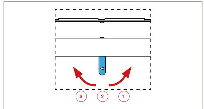
Abb. 24: Verstellhebel „Zuluft“ – Positionen für Ekko R
