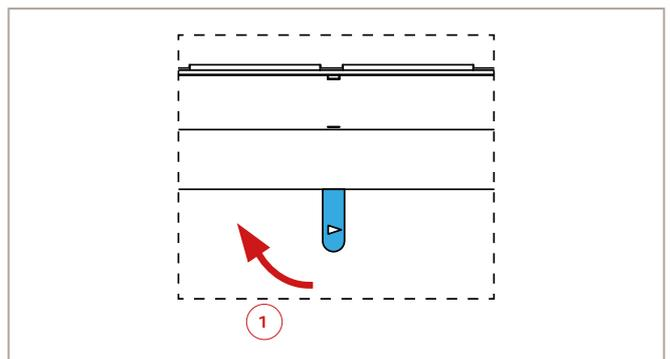
Abb. 26: Verstellhebel „Zuluft“ – Position 1
