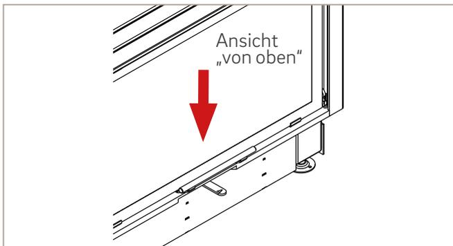
Abb. 22: Verstellhebel „Zuluft“
