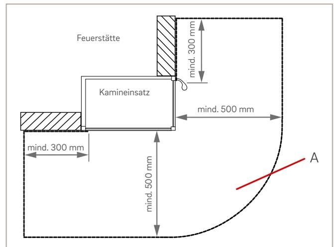
Abb. 3: Fußbodenschutz im Bereich vor der Feuerraumöffnung, Ekko
